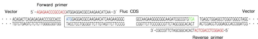
图 3. 目标 CDS 片段的扩增 (例: FLuc)
